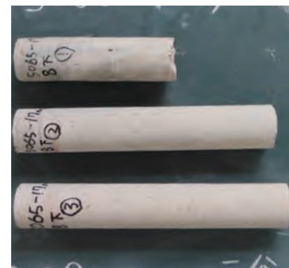
杭周固定部コア
